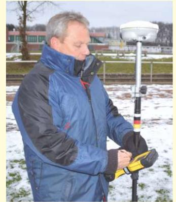
Luftbildauswerter Klaus Niehoff (li.) gibt die Koordinaten eines möglichen Blindgänger-Verdachtspunktes in einen speziellen GPS-Empfänger ein. Der Verdachtspunkt wird im Gelände dann mit einem kleinen Stab markiert.
