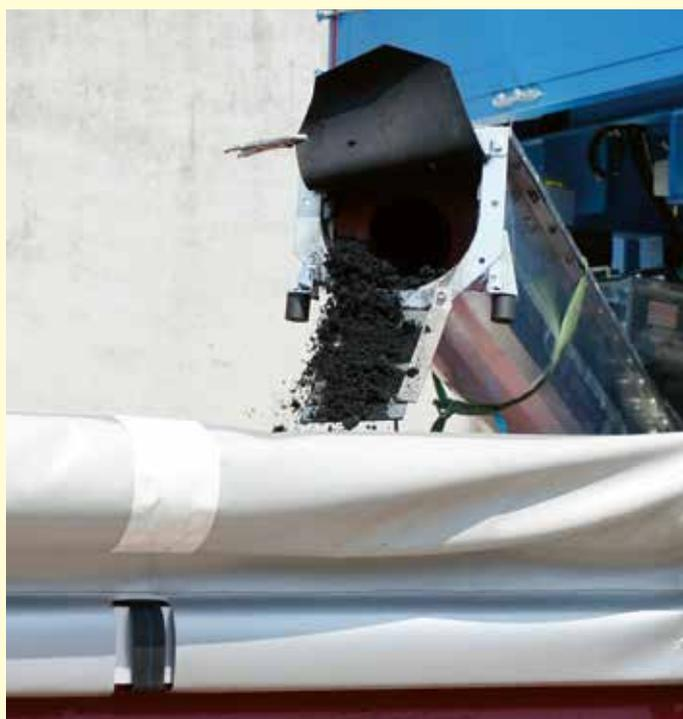
Entwässertes Klärschlamm wird abgefahren.
